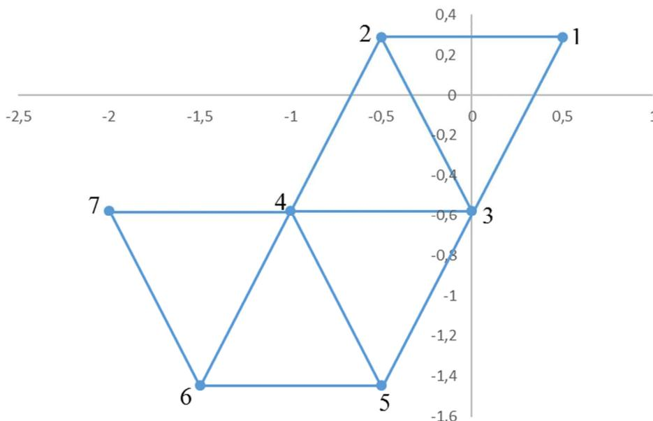
Рисунок 2 – Метод последовательного симплекс-метода.
