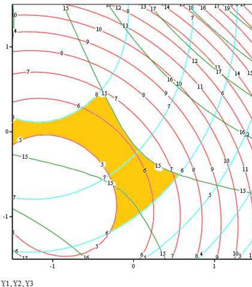
Рисунок 4 - Совмещенные контурные кривые зависимости показателей свойств от содержания серы и технического углерода П-803.
